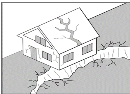
รูปที่ 23 รูปตัวอย่างการหลุดตัวของพื้นดินบริเวณที่ตั้งอาคาร
